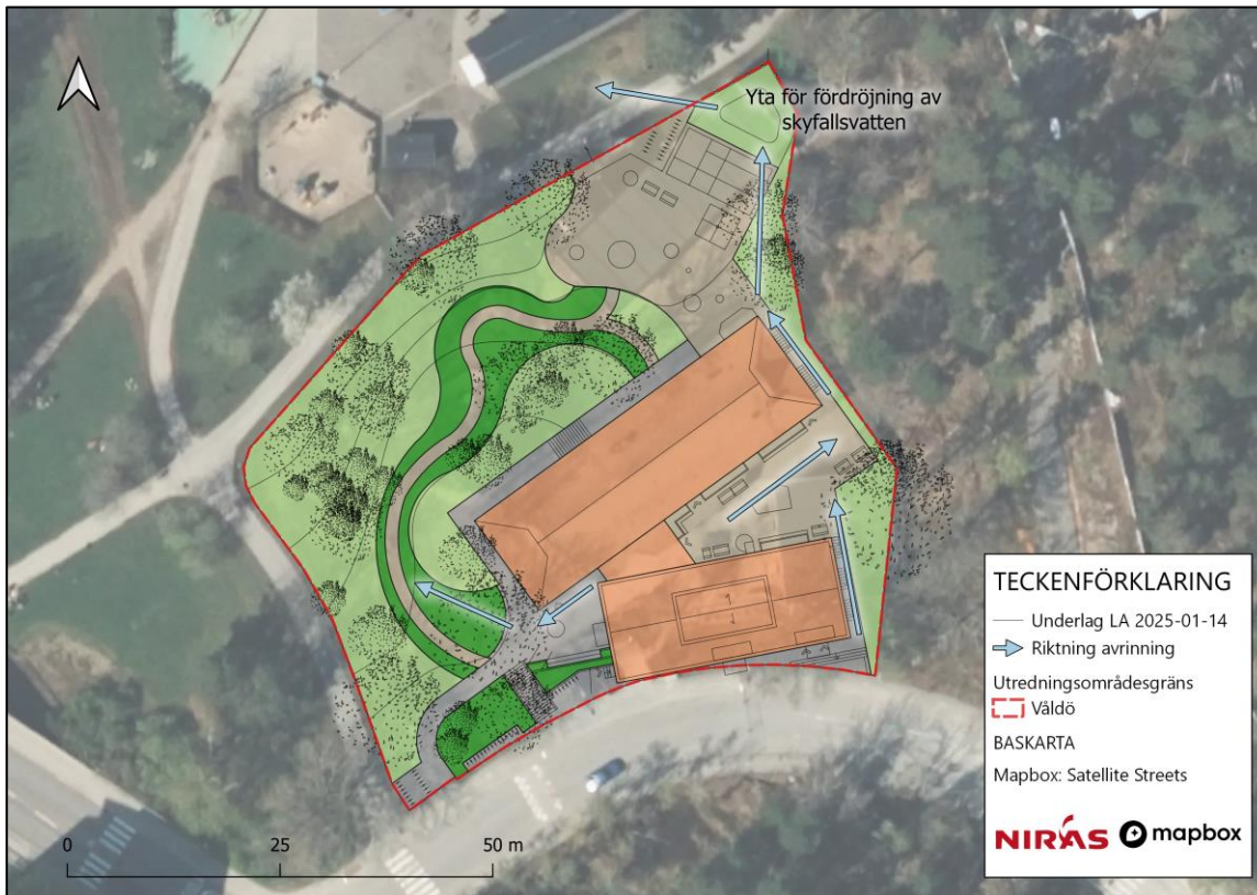
Figur 10.1 Rekommendationer för avledning av vatten vid en skyfallshändelse, samt markering för planerat yta som kan nyttjas för fördröjning av erforderlig volym om 16 m 3 för att kompensera bortbyggandet av lågpunkter.
