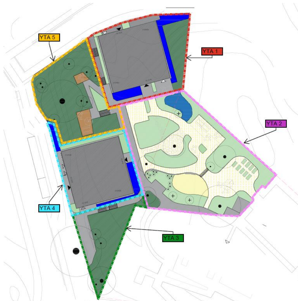
Figur 16. Ytor som ansluter till respektive dagvattenanläggning Kv. Färebo
