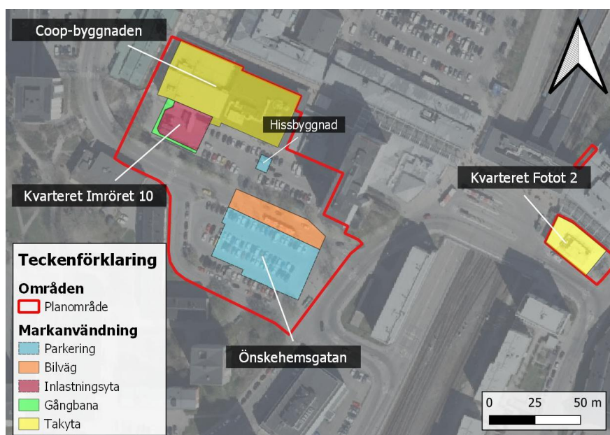
Figur 5. Markkartering enligt befintlig situation. Fotavtrycket av husen (framtida fastigheterna) på Imröret 10 och Önskehemsgatan består idag av inlastningsyta, parkering, bilväg och gångbana. Kv. Fotot 2 i öster utgörs idag av en befintlig byggnad. Ortofoto: (Lantmäteriet, 2024c)
