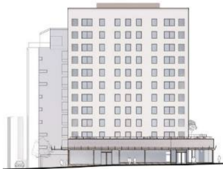
Bild som visar kvarter Fotots fasad mot Högdalsgängen, med glasad sockelvåning och bostadsdel. (Equator)
