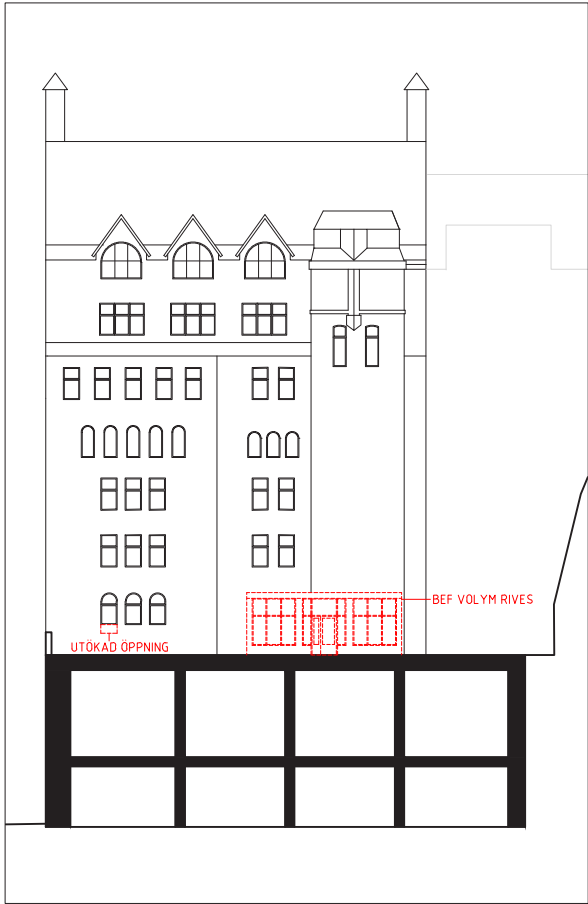
SEKTION B - BEFINTLIG FASAD RIVNING
