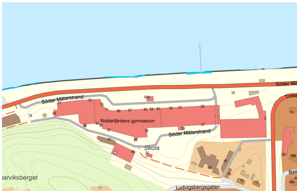
Figur 15 Simulerad översvämning med en vattennivå på + 1,5 meter i RH200 från Mälaren visas med mörkare blå områden. Simulering hämtad från Översvämningssportalen, MSB.
