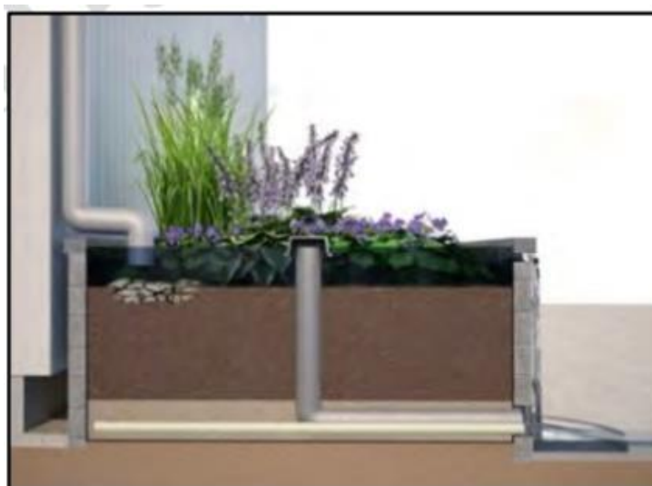
Figur 30 Schematisk skiss förhöjd växtbädd, sidovy
