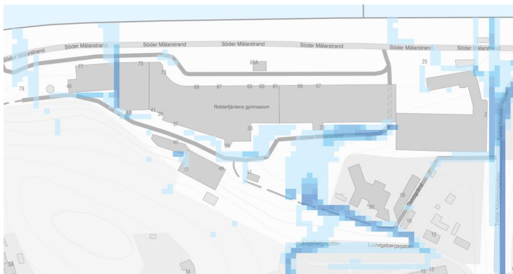
Figur 21 Simulerat flöde under skyfall enligt Stockholms stads skyfallsmodellering. Lågt till högt flöde illustreras med ljus till mörkt blå färg. (Stockholm stad, Miljödataportalen)
