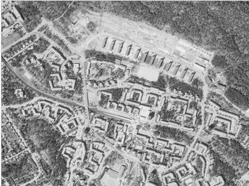
Ortofoto över Bagarmossen i slutet av 1960-talet. Vid fototillfället var husen på Byälvsvägen under uppbyggnad och det ger en bild av hur marken hanterades. Som synes finns ingen äldre vegetation kvar efter markberedningen inför byggentreprenaden. Ortofoto: www.lantmateriet.se 2020-02-10.
