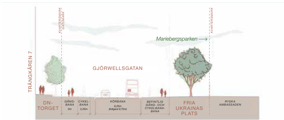
Principsektion B: Gjørwellsgatan vid Signalhuset
