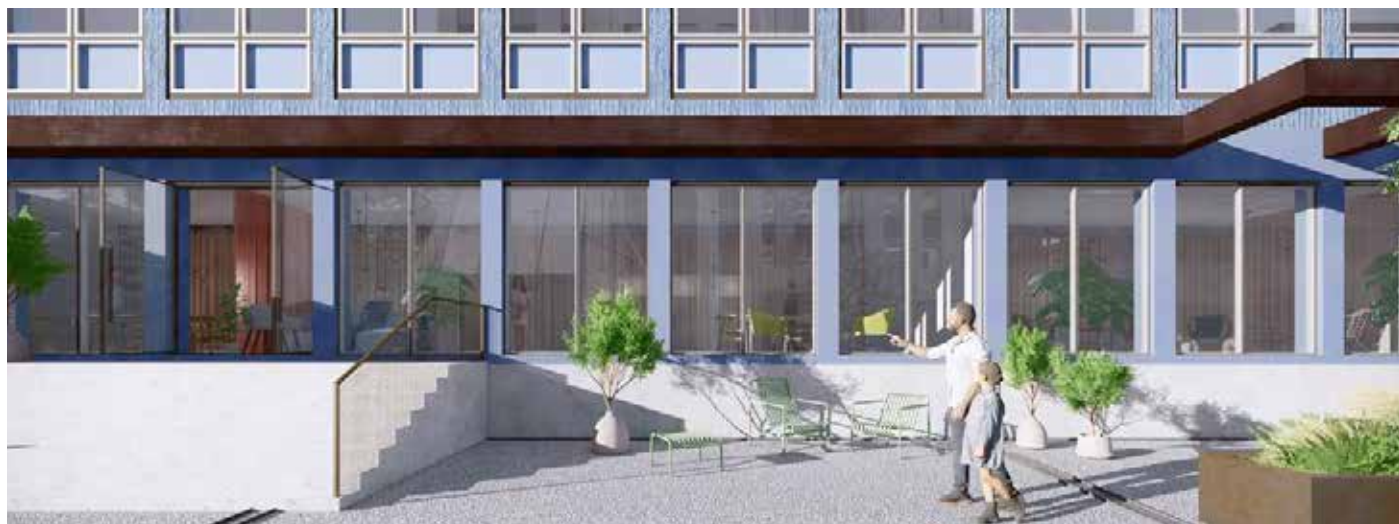
Alternativ Small. Befintliga fönsterhål bevaras och partier ersätts med nya med glas till golv. På valda ställen, till exempel vid miniparken adderas dörrar och trappor/ramper till Lastgatan.
