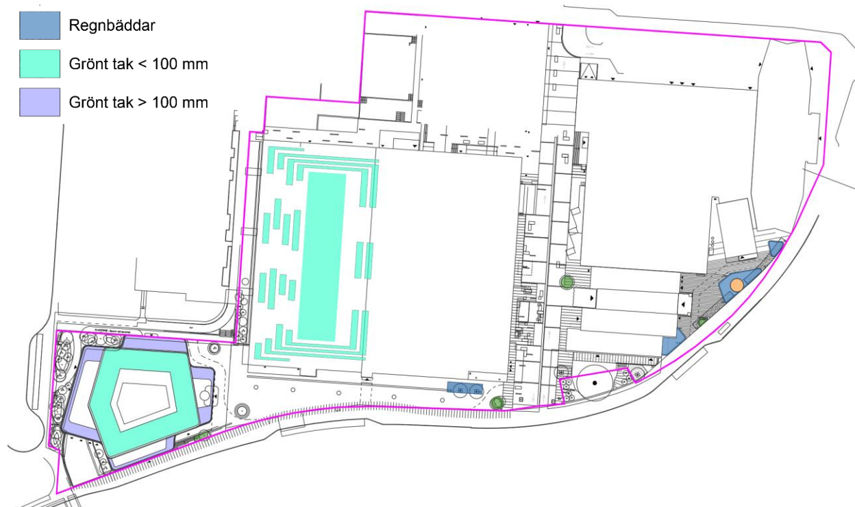
Figur 31 Översikt över föreslagna dagvattenanläggningar
