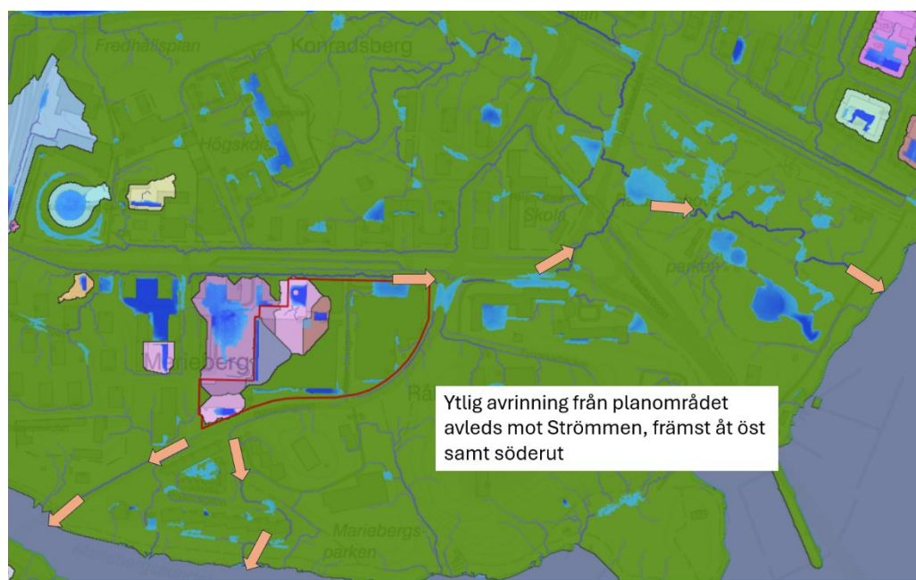
Figur 15 Ytlig avrinning sker till Strömmen främst åt öster samt mot söder (pilar visar större avrinningsleder)
