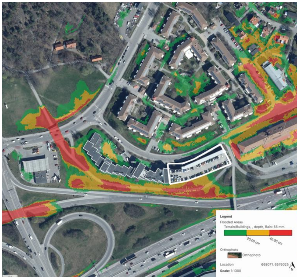
Figur 9. Fastighetsgränsen är markerat i vitt. 55 mm regn har lagts på i Scalgo Live. Vattendjup upp till 20 cm i grönt, vattendjup mellan 20–40 cm i gult, vattendjup över 40 cm i rött.
