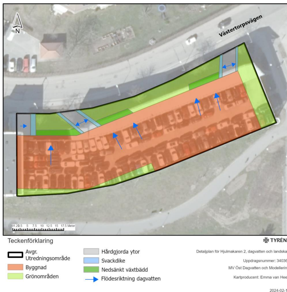
Figur 13. Principskiss för flödesriktningen av dagvattnet. För mer detaljerad utformning av pergola med växtbäddar, se PM Landskap för Hjulmakaren 2 i Hägersten, Stockholm (Tyréns 2024).
