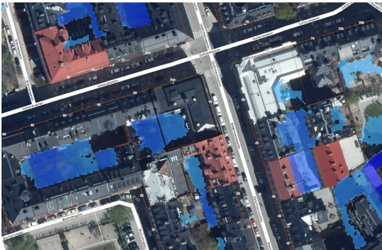
Figur 5. Skyfallskartering, utförd i Scalgo. Karteringen redovisar ett 106 mm regn utan infiltration. Fastigheten är merad med svart.
