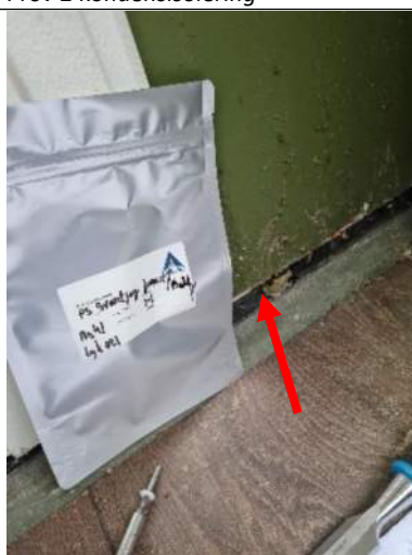
Prov 5. Svart fogmassa, innehåller klorparaffiner.
