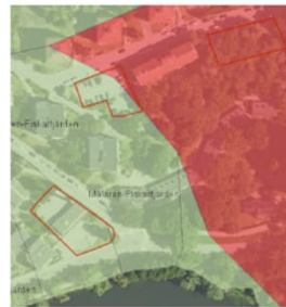
Figur 4. Tekniska avrinningsområden för dagvatten. Gröna ytor är inom avrinningsområde till Mälaren-Fiskarfjärden, röda ytor till Himmerfjärden. Ungefärligt planområde inom röda marker.
