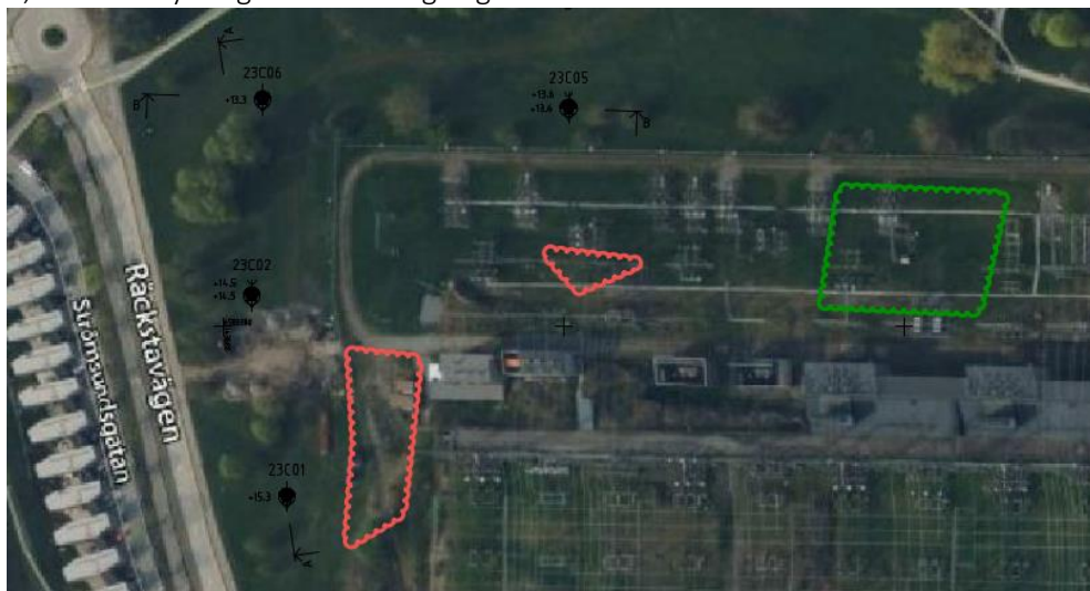
Figur 6: Ungefärlig placering av observerat djup till berg i dagen, alternativt ytligt berg.
