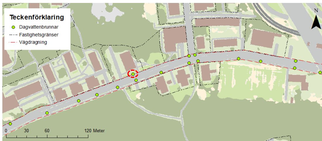
Figur 6. Placering av dagvattenbrunnar längs med Gröndalsvägen. Röd ring markerar brunn med sidoinlopp.
