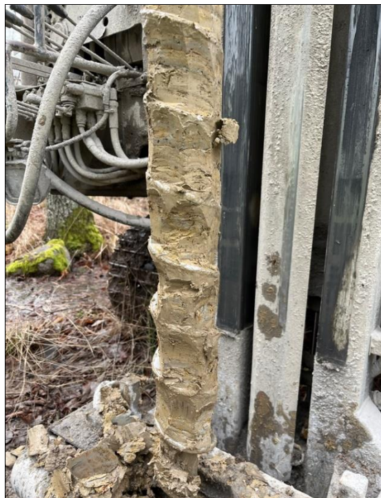
Foto 6. Borrpunkt 25NC07 1,2-2,0 m. Lera med finsandskikt.
