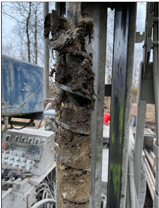
Foto 5. Borrpunkt 25NC04 0-0,5 m. Humusjord och torrskorpelera.
