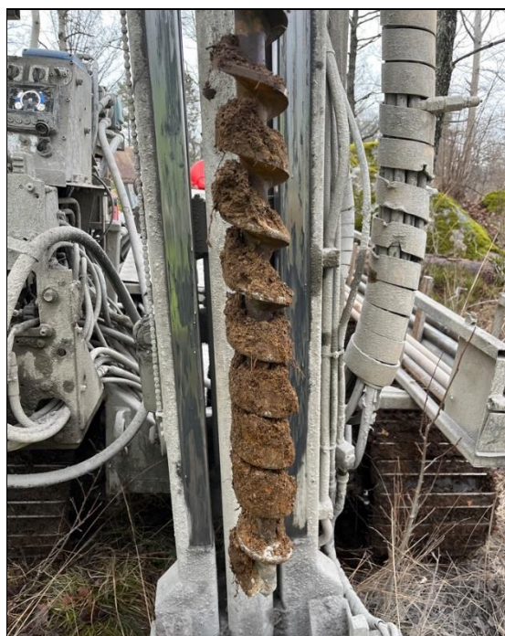
Foto 8. Borrpunkt 25NC110-0,7 m. Humusjord och siltig sand.
