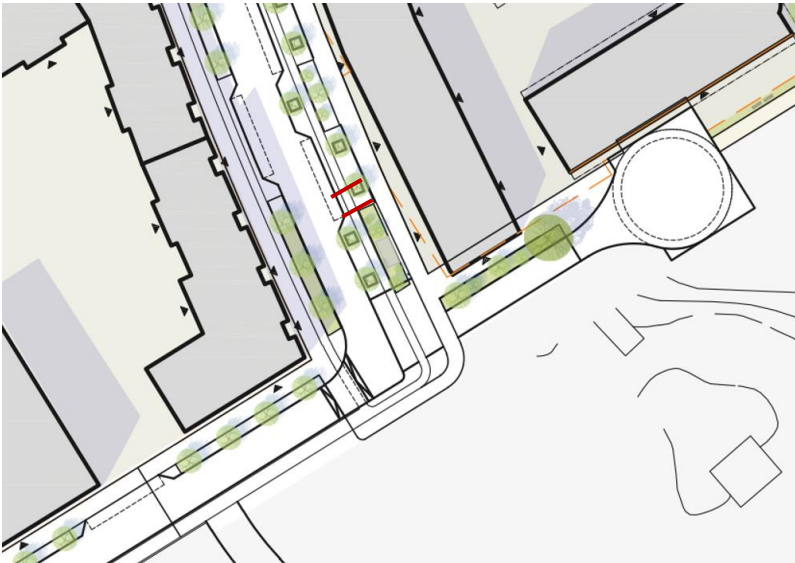
Figur 53. Översikt övergångsställe och cykelpassage över Smältvägens förlängning. Förslag till övergångsställe över Smältvägen som studerats i utredningen illustreras med röd markering.
