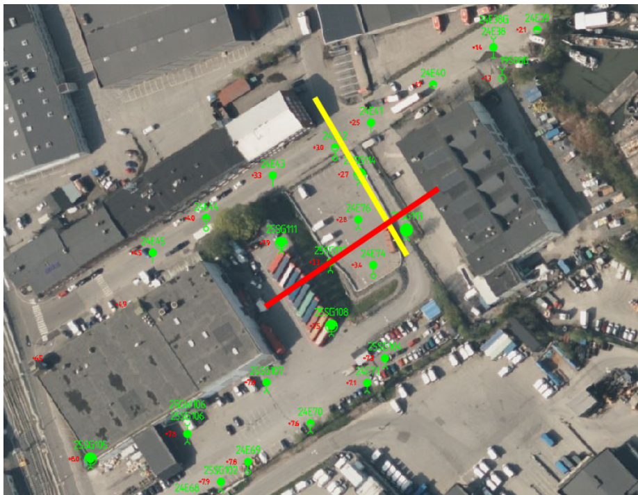
Figur 6. Sektioner för stabilitetsberäkningar. Röd linje är beräknad sektion för befintliga förhållanden. Gul linje är beräknad sektion för eventuella uppfyllnader.
