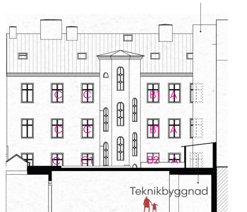
Befintlig fasad med ventilationskanal och teknikbyggnad mot fastighetsgräns i söder.
