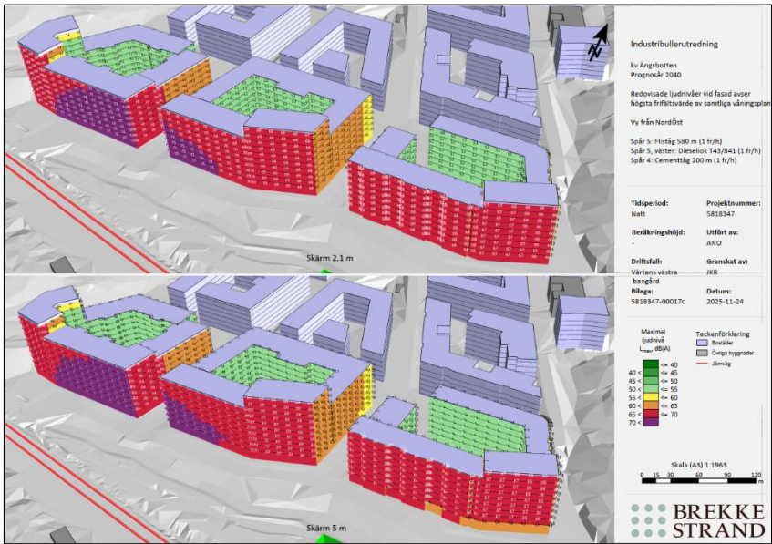
Figur 7-20. Maximala ljudnivåer för industribuller nattetid, vy från söder. Jämförelse mellan scenario med en 2,1 meter hög skärm respektive 5,0 meter hög skärm (Brekke & Strand Akustik AB, 2025).
