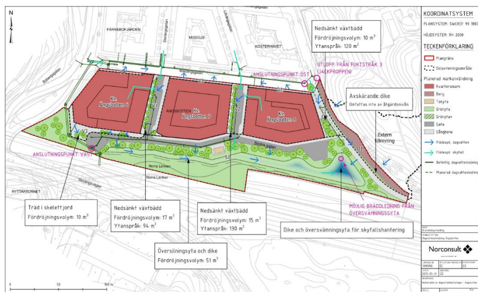
Figur 7-30. Schematisk helhetsbild över dagvattenhanteringen för allmän platsmark. Angivna volymer avser erforderliga fördröjningsvolymer för respektive delavrinningsområde (Norconsult, 2025).
