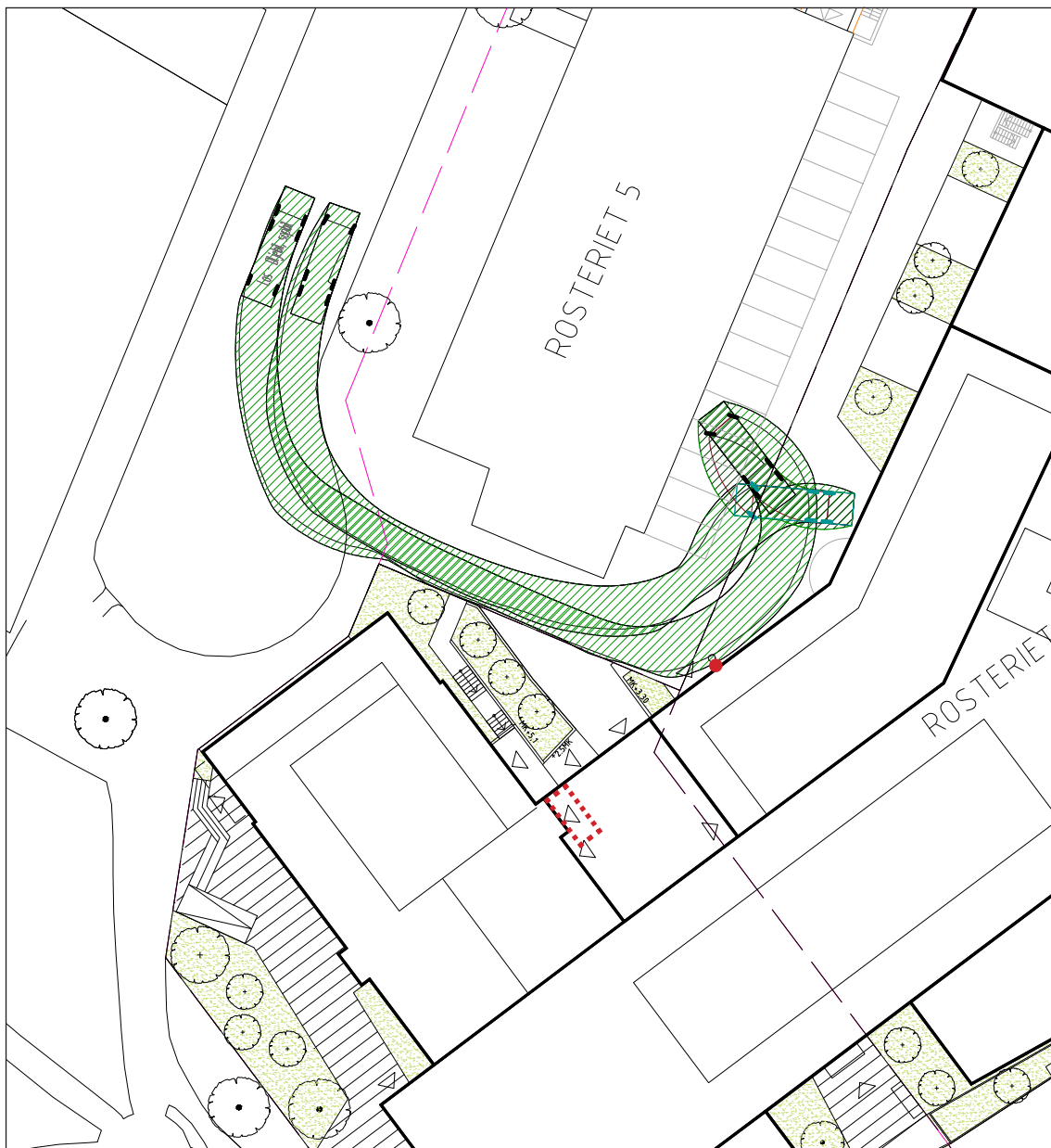
Figur 13 Körspår vändning i "gränden" för typfordon Los (sopbil 9,4 meter). Parkering på Rosteriet 5 påverkas. Röd prick visar tömningspunkt för fettauskiljare och röstreckad linje visar fettauskiljarens ungefärliga placering i byggnad.
