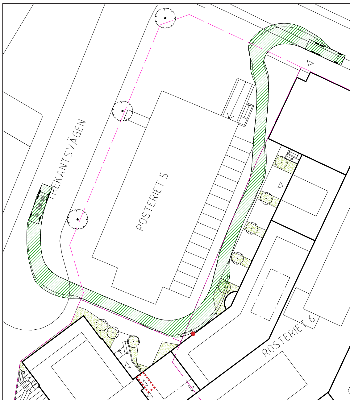
Figur 11 Körspår för angöring vid nytt miljörum och utfart via "gränden" högerut på Lövholsvägen. Röd prick visar tömningspunkt för fettavskiljare och röstreckad linje visar fettavskiljarens ungefärliga placering i byggnad.
