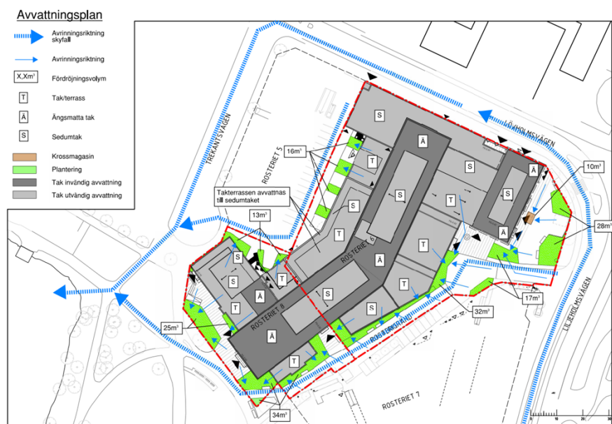
Föreslagna dagvattenåtgärder, samt skyfallsvägar. (Bild Structor)
