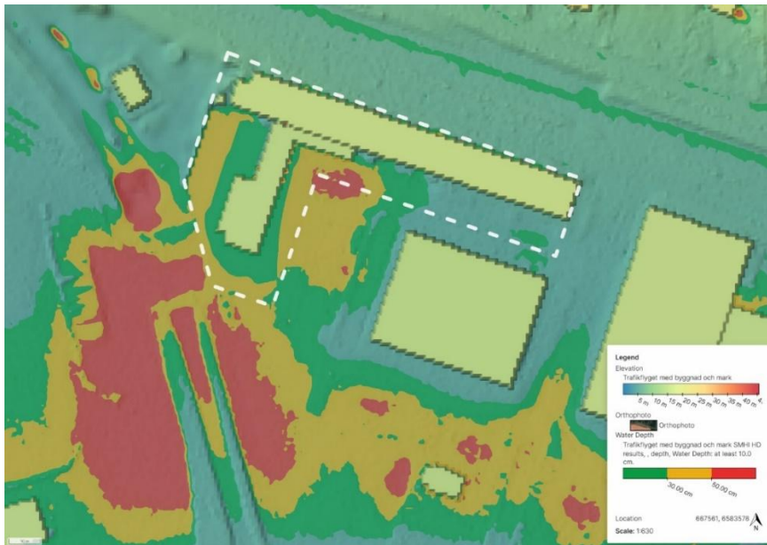
Figur 8-8. Maxdjup som överskrider 10 cm vid 100-årsregn med klimatfaktor 1,4 i planerad situation.
