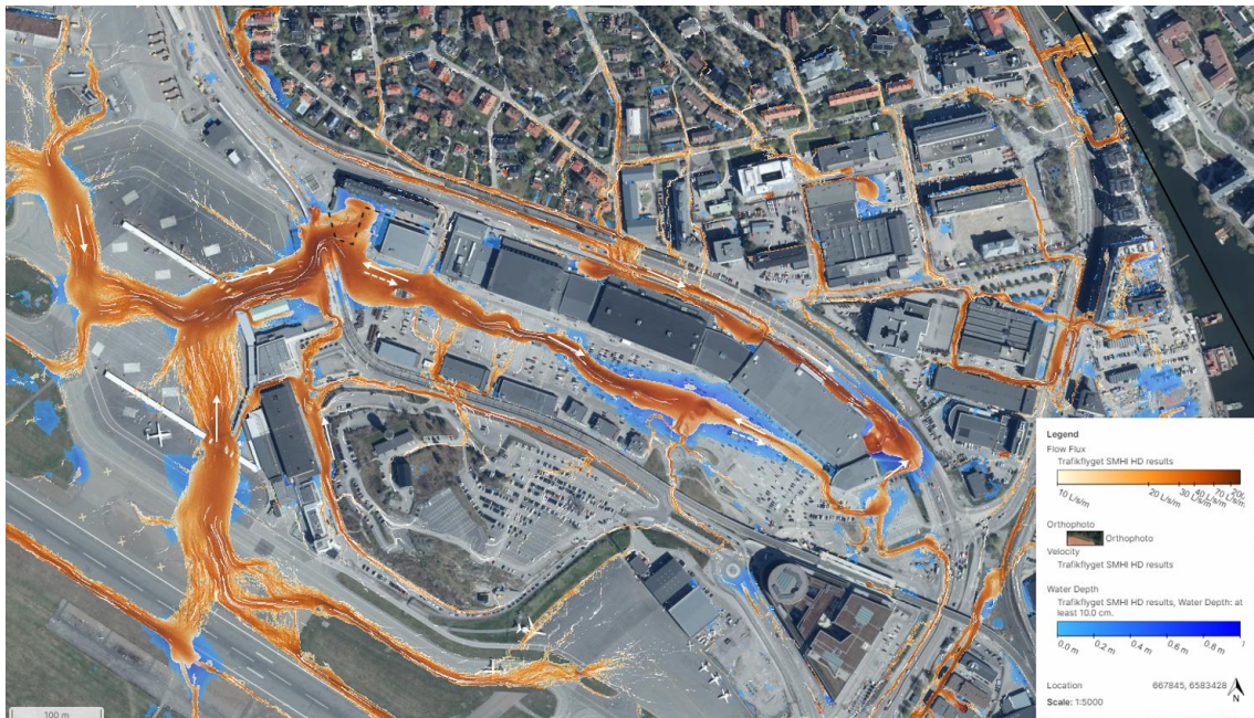
Figur 8-5. Maxflöde (orange) och maxdjup (blått) vid 100-årsregn klimatfaktor 1,4. Utredningsområde markerat i svart. Vita pilar visar rinnriktning. Streckade pilar visar rinnriktning under senare del av regnet när lågpunkten är full.
