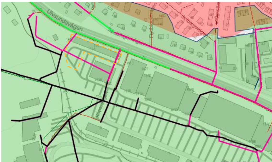
Figur 8-1. Kapacitet i SVOA:s dagvattenledning. Färger visar trycknivåer vid 10-årsregn där grön=vattennivå upp till ledningens hjäss, röd, vattennivå från hjäss + 500 mm. rosa= vattennivå upp till markytan, svart=vattennivå över markytan. Utredningsområdet markerat i gult.
