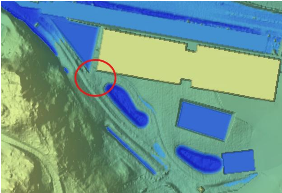
Figur 31. Skisserad ungefärlig omfattning av de multifunktionella idrottsytorna. Tröskeln som bestämmer vattennivån i dammsystemet vid skyfall är markerad med röd cirkel. Exakta läget för de föreslagna ytorna har ej studerats närmare utan redovisas endast schematiskt. Placering och utformning av ytorna ska så långt som möjligt ta hänsyn till både ledningar i mark och befintlig gestaltning av dammar och park.
