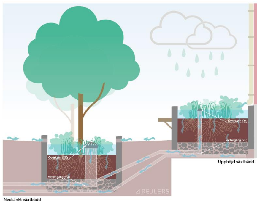
Figur 9-1. Illustration av både nedsänkt och upphöjd växtbädd.
