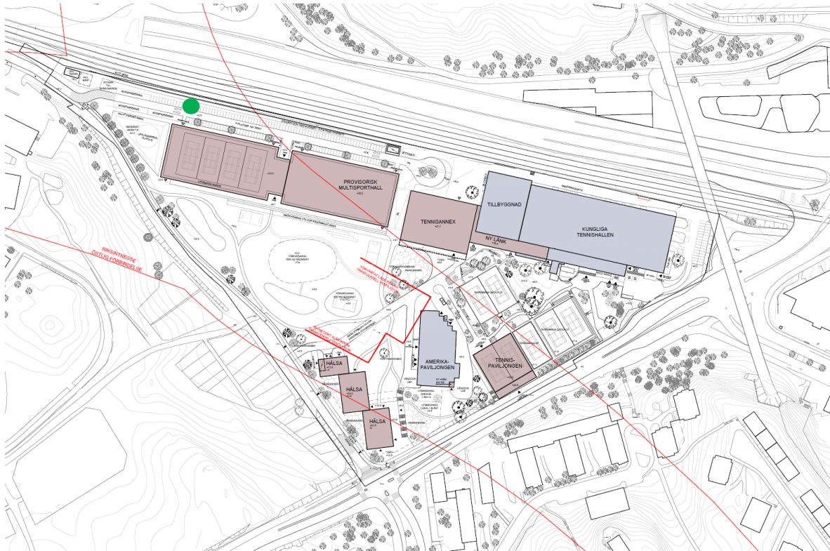
Figur 12. Skiss som redogör möjlig placering av luftutbytesstation tillsammans med ventilationstorn inom planområdet. Se grön markering.
