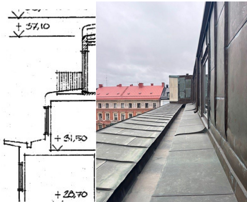
Bilden till vänster visar sektion på ursprunglig utstickande takfotsgesims och det karaktäristiska rundade taket. Bilden till höger visar takfotsgesimsens bruna kopparkulör och utförande sett från plan 7 mot Nybrogatan. Bild: Nyréns och Stadsbyggnadskontoret.
