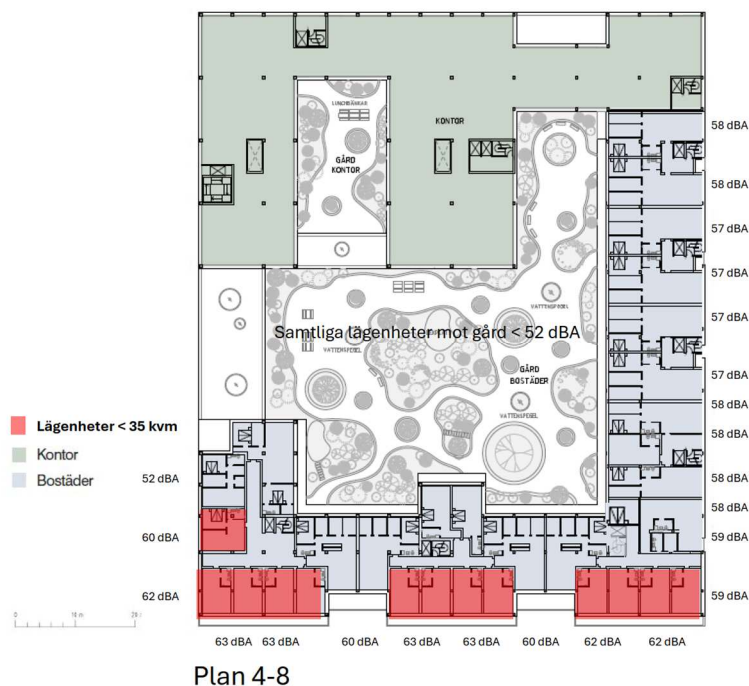
Figur 4. Ekvivalent ljudnivå vid bostadsfasad till planerade lägenheter på plan 4–8.
