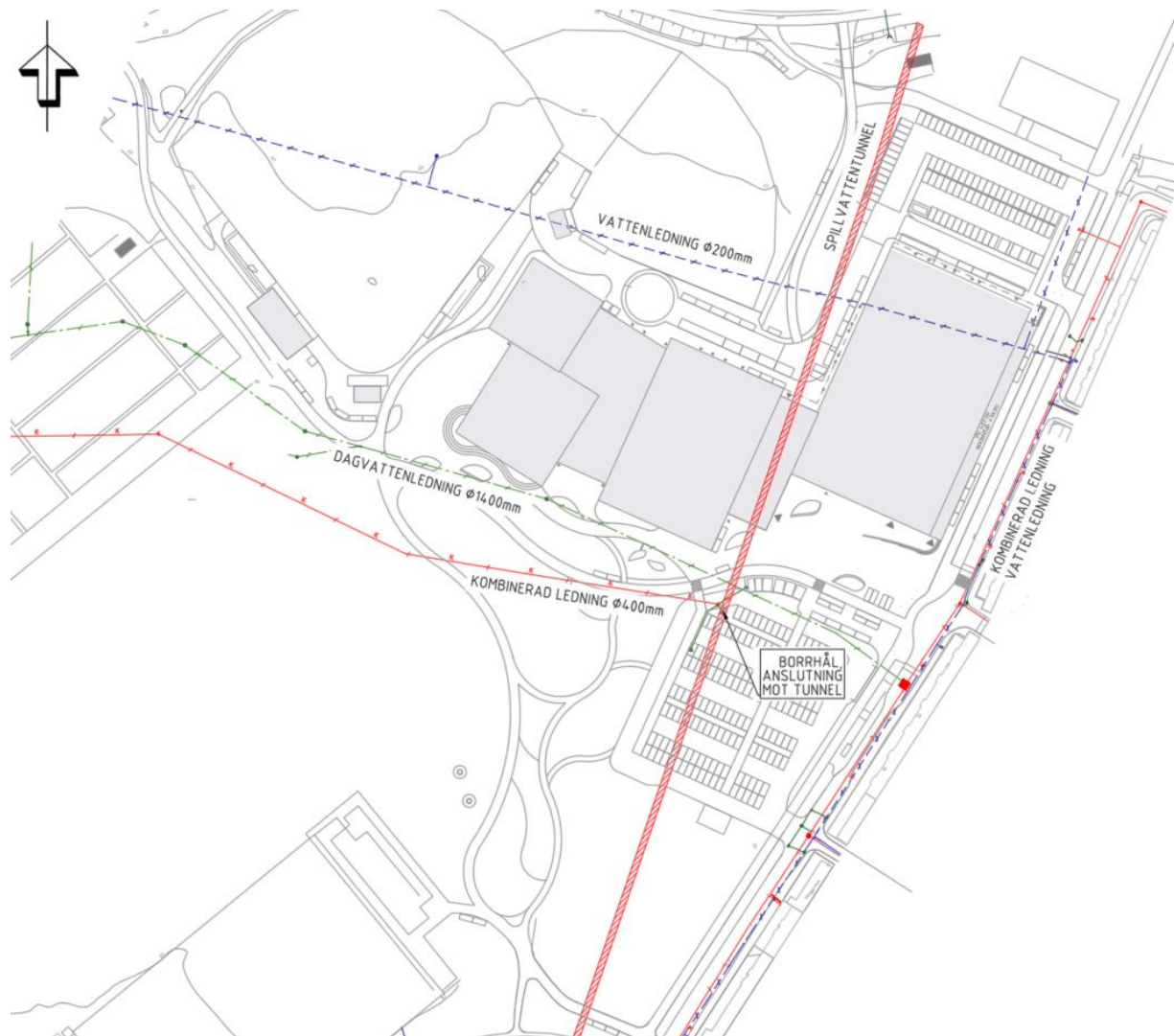
Figur 9. Befintliga VA-ledningar inom området.
