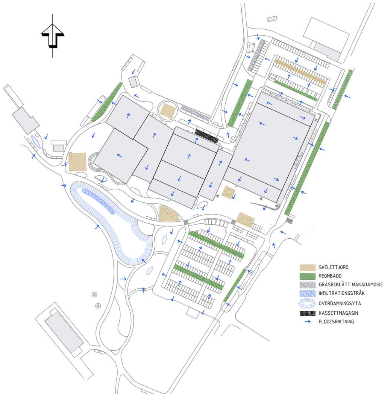
Figur 14. Översiktlig placering och omfattning av föreslagna fördröjningslösningar.
