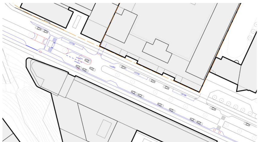
Figur 33 - Föreslagen gatuutformning för att möta de trafikala behov som exploateringen väntas ha. Förslaget är att mittremsan utnyttjas för att möjliggöra vänstersväng in till Bremen 1 utan att hindra bakomvarande trafik från att passera. Tyréns.
