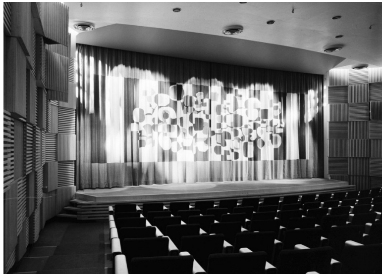
Figur 8 - Hörsalen, idag kallad Bremensalen, med inredning av Sven Kai-Larsen. Väggar och dörrar i salen var klädda med isolerande träpaneler i form av kuber placerade med viss förskjutning. Foto: kulturmiljöutredning, Tyréns.
