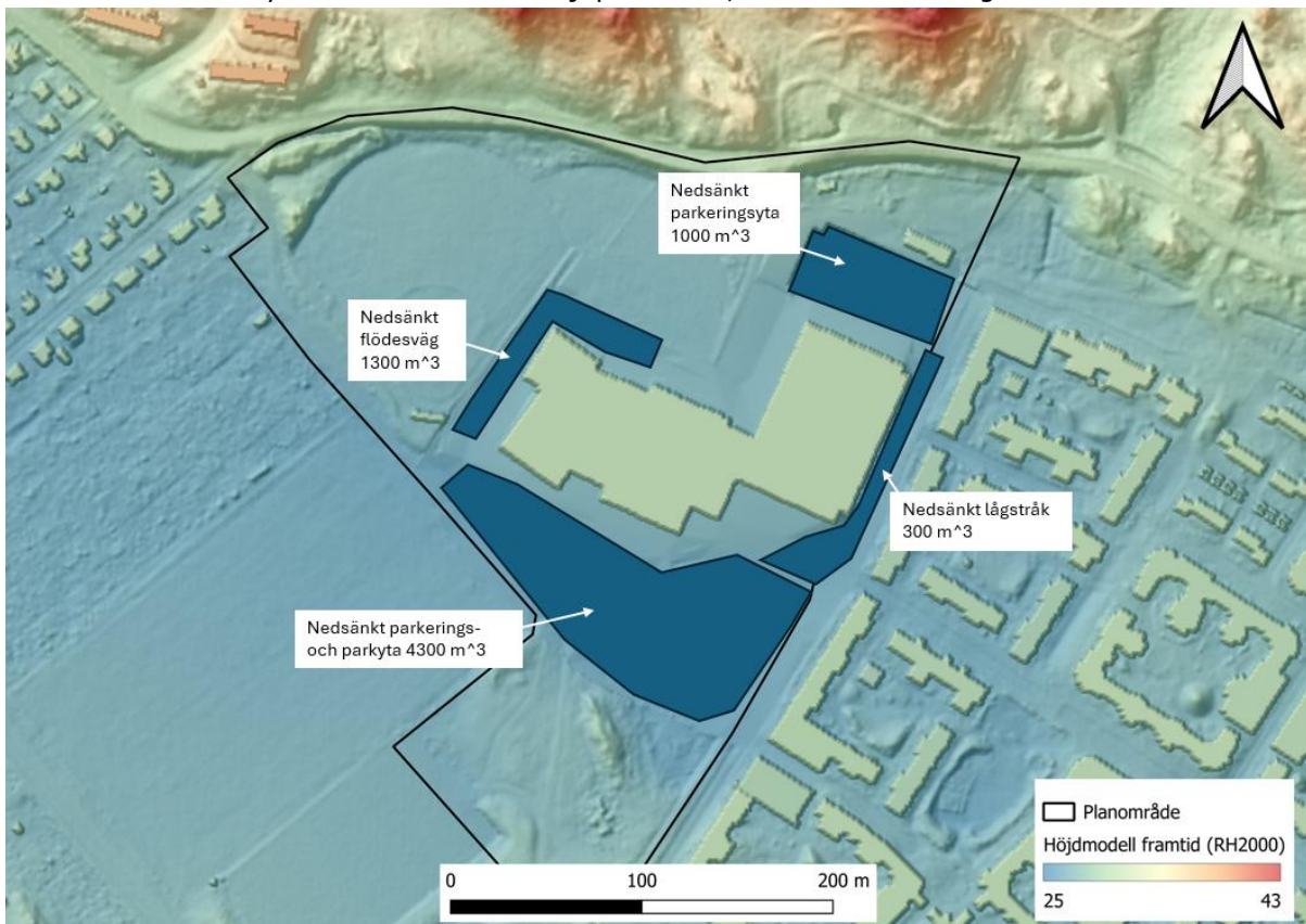
Figur 7. Framtida höjdsättning och placering av skyfallsåtgärder inom planområdet. Blå polygoner visar fördröjningsytor med ungefärliga schaktvolymer.
