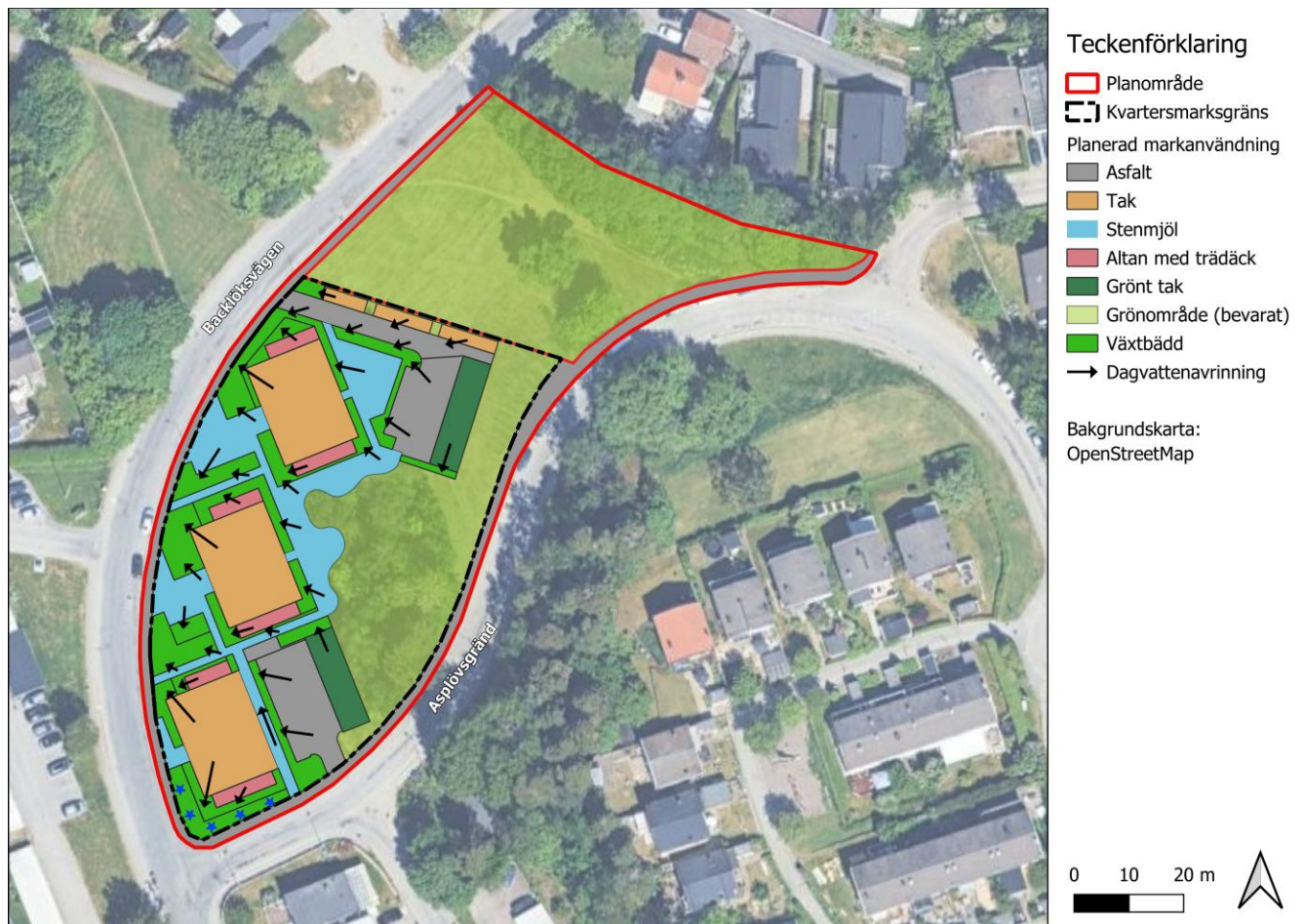
Figur 18. Systemlösning för omhändertagande av dagvatten i växtbäddar på kvartersmark.
