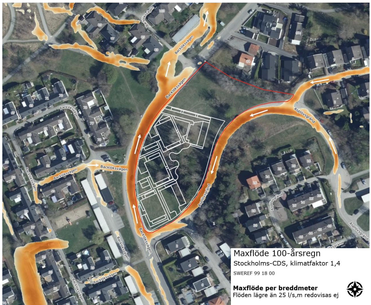
Figur 7. Maximala flöden inom och i anslutning till planområdet vid ett regionalt anpassat 100-årsregn med klimatkfaktor 1,4 (Stockholms stad, 2024). Mörkare färg indikerar högre flöde. Planområde markeras med röd polygon, flödesriktning visas med vita pilar.
