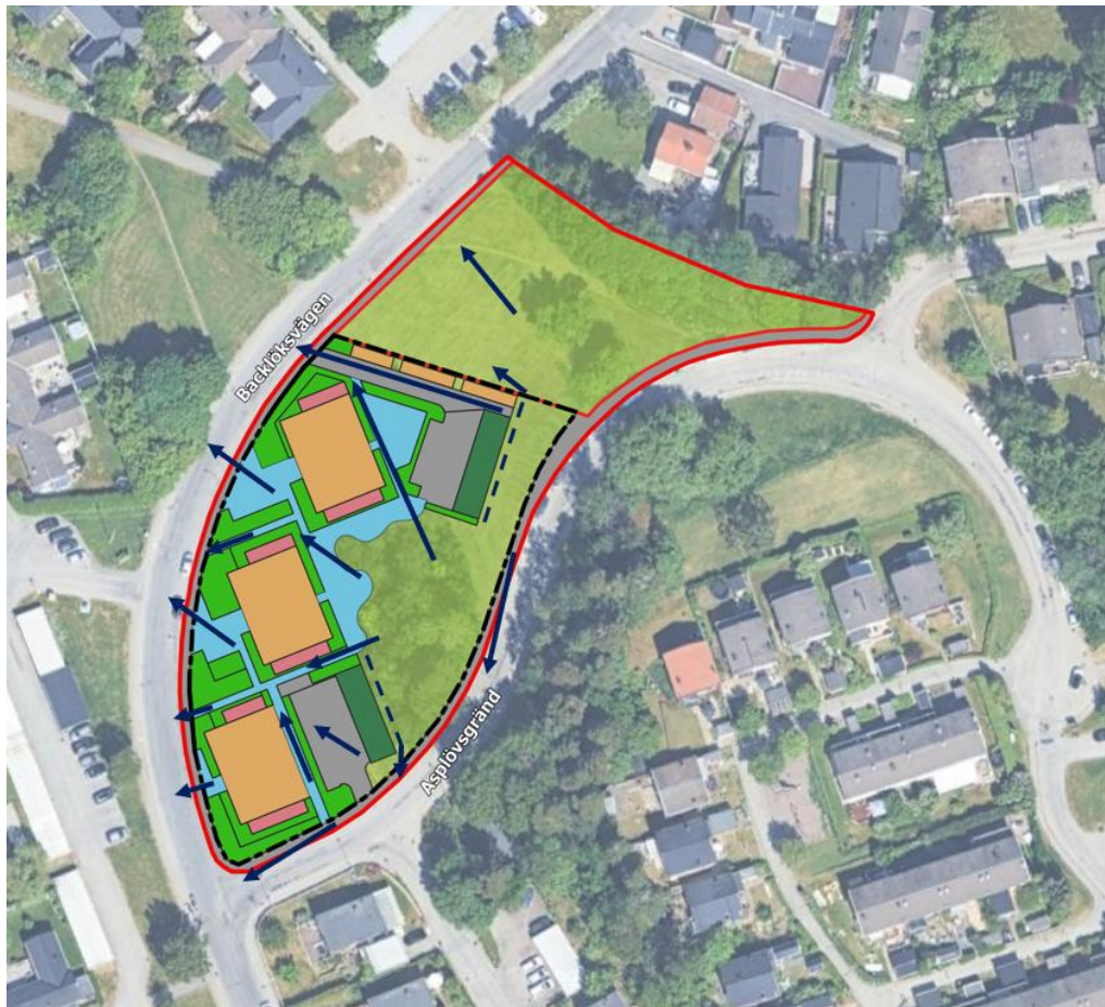
Figur 17. Figuren visar avledningvägar för naturmarksvatten och större flöden med mörkblå pilar. Streckade linjer markerar föreslagen placering av avskärande diken.
