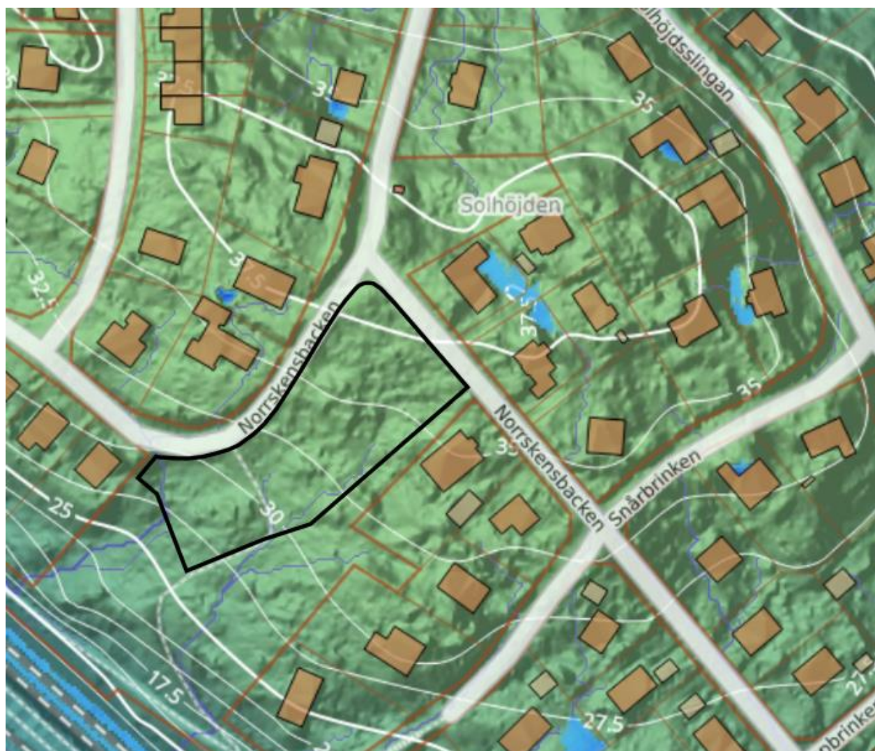
Figur 7. Flödesvägar (blå linjer) genom området vid ett 100-årsregn, ScalgoLive. Utredningsområdet markerat ungefärligt med svart. Pilar visar flödesriktning.
