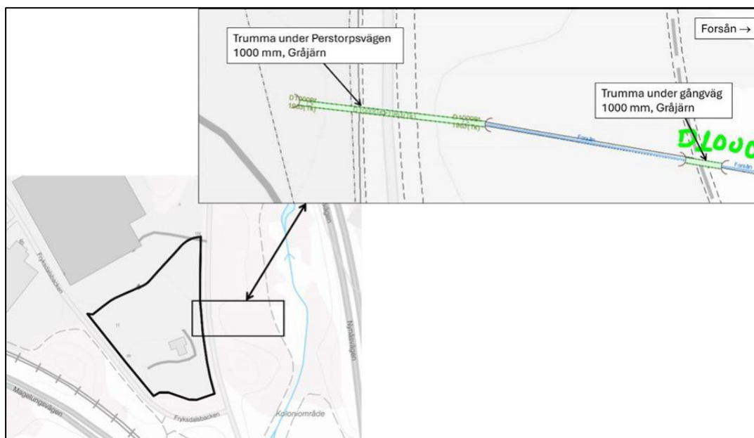
Figur 11 Trumma under Perstorpsvägen med inlopp i planområdet och utlopp i ett dike som leder till Forsån. Källa: Trafikkontoret, 2024. Figur hämtad från Skyfallsutredning (WSP, 2026a).
