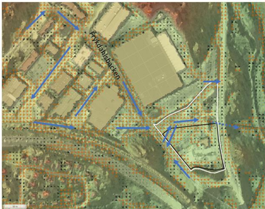
Figur 21. Figur från Presentation Skyfallshantering Fejan 2026-02-03. Figuren visar flödesvägar vid ett skyfall.
