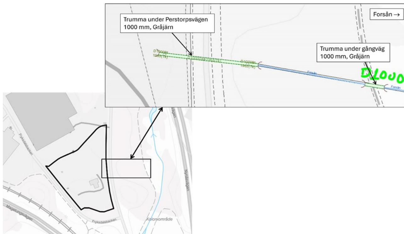
Figur 6. Trumma under Perstorpsvägen med inlopp i utredningsområdet och utlopp i ett dike som leder till Forsån. Källa: Trafikkontoret, 2024.
