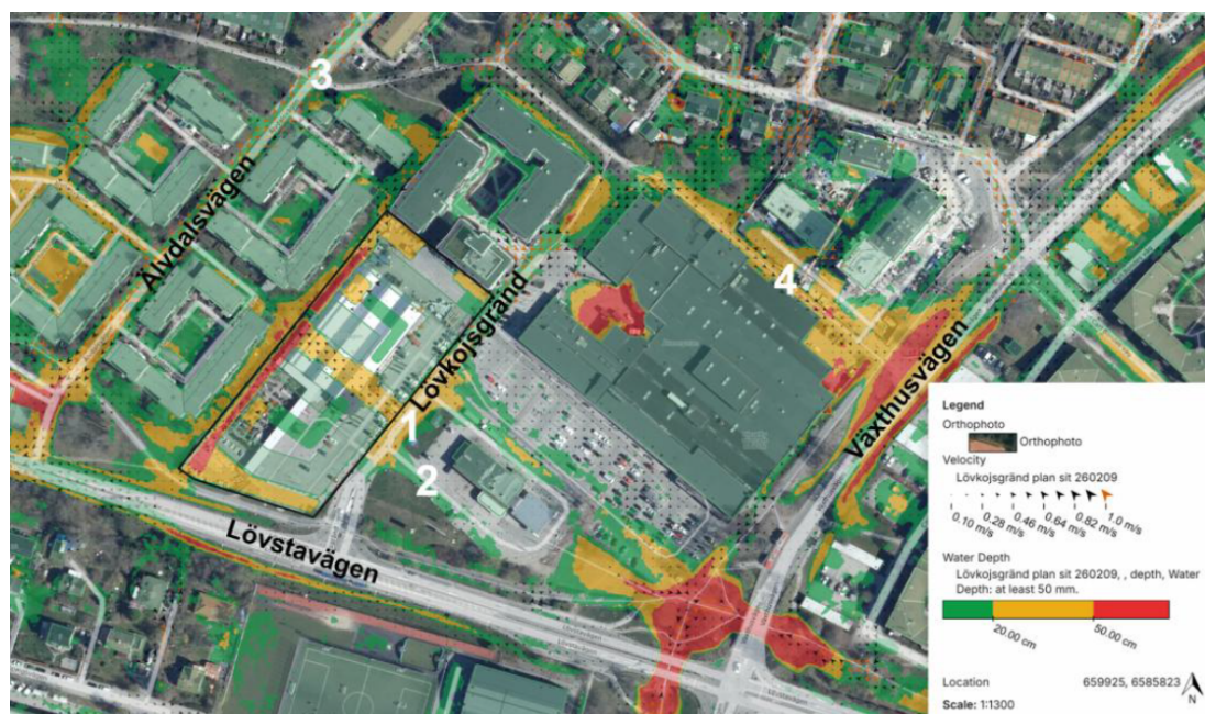
Maximala vattendjup och vattenhastigheter vid framtida 100-årsregn. Bild: Structor 2026.
