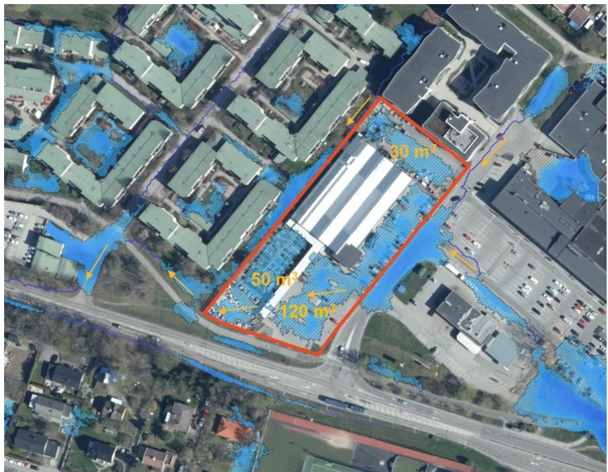
Lågpunkter med fördröjningsvolym samt rinnvägar (orangea pilar).
