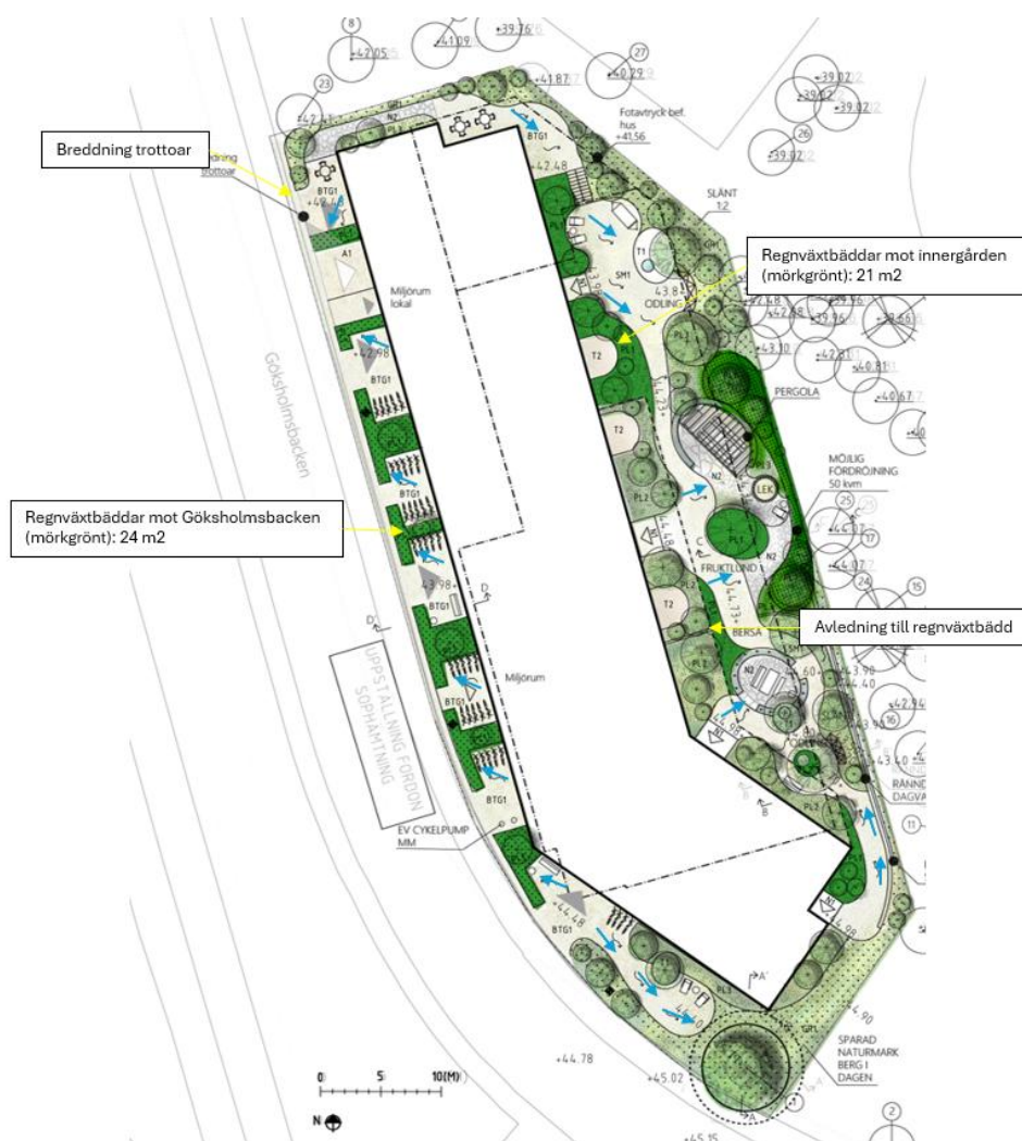
Figur 14. Principlösning LOD efter exploatering. Regnväxtbäddar i mörkgrönt.
