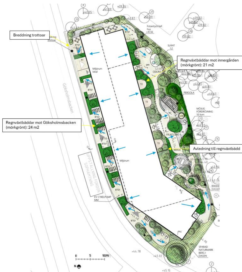
Figur 9. Förslag på placering av LOD-åtgärder (mörkgrön färg). Flödespilar i blått.
