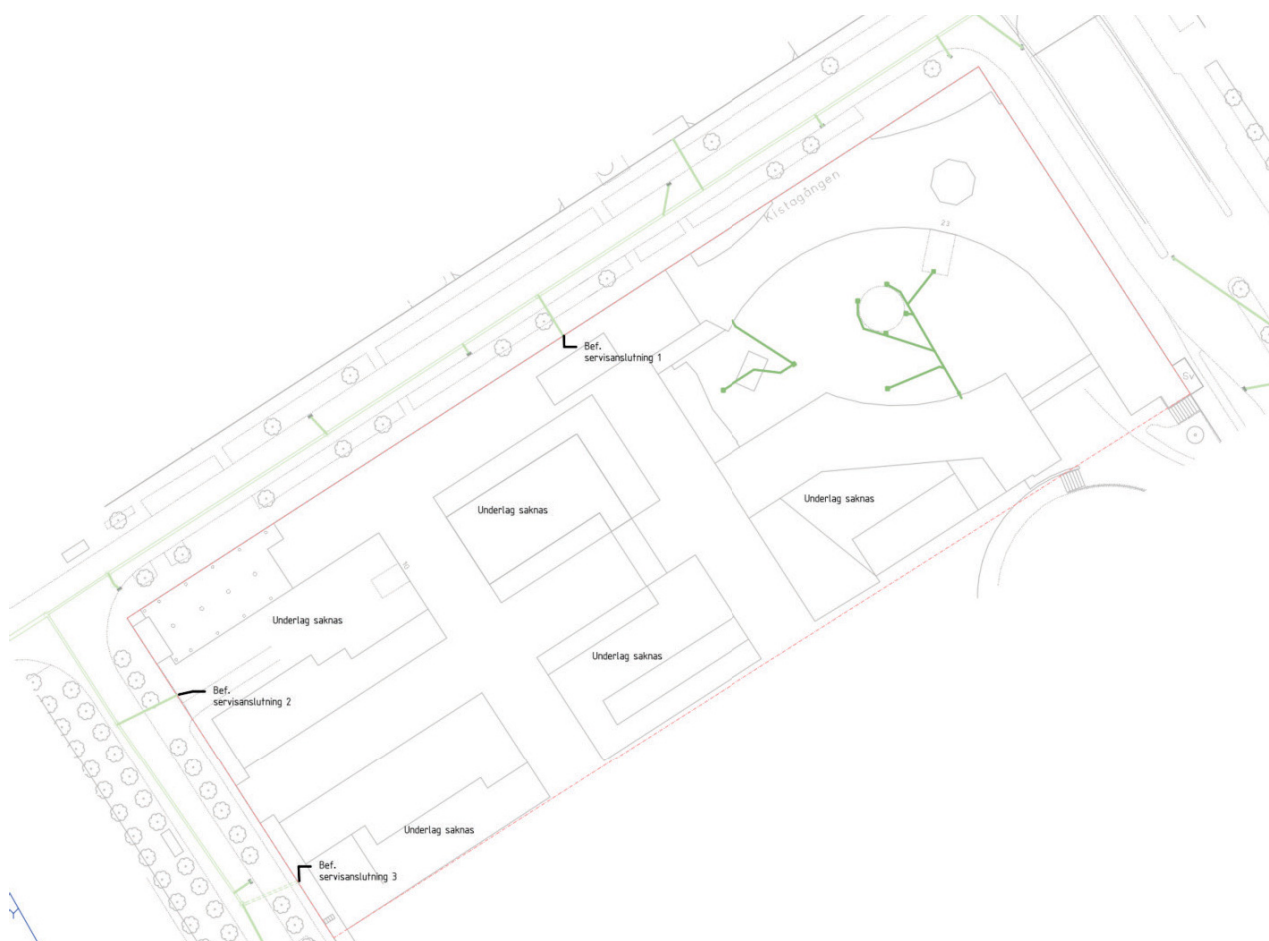
Figur 7. Befintliga kommunala dagvattenledningar (ljusgrönt) samt tolkade befintliga ledningar inom kvartersmark (mörkgrönt). Underlaget för kvartersmark är ej komplett. Enligt ledningskarta erhållen från Stockholms stad 2026-04-23 samt tolkat från äldre relationsritningar (1992-03-12).
