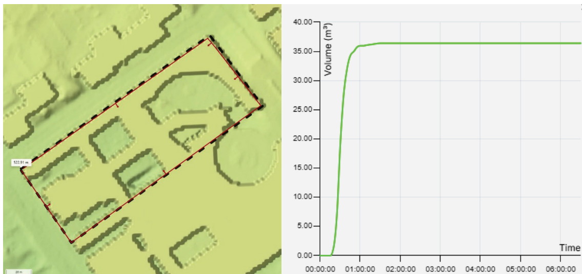
Figur 17. Graf som visar hur stor volym vatten som avrunnit från planområdet vid den röddragna linjen (motsatt riktning mot vad pilarna visar) vid en viss tidpunkt under ett 100-årsregn med klimatfaktor 1,4 (Stockholmsregn). Underlag från Scalgo/Stockholms skyfallsmodell, 2026.
