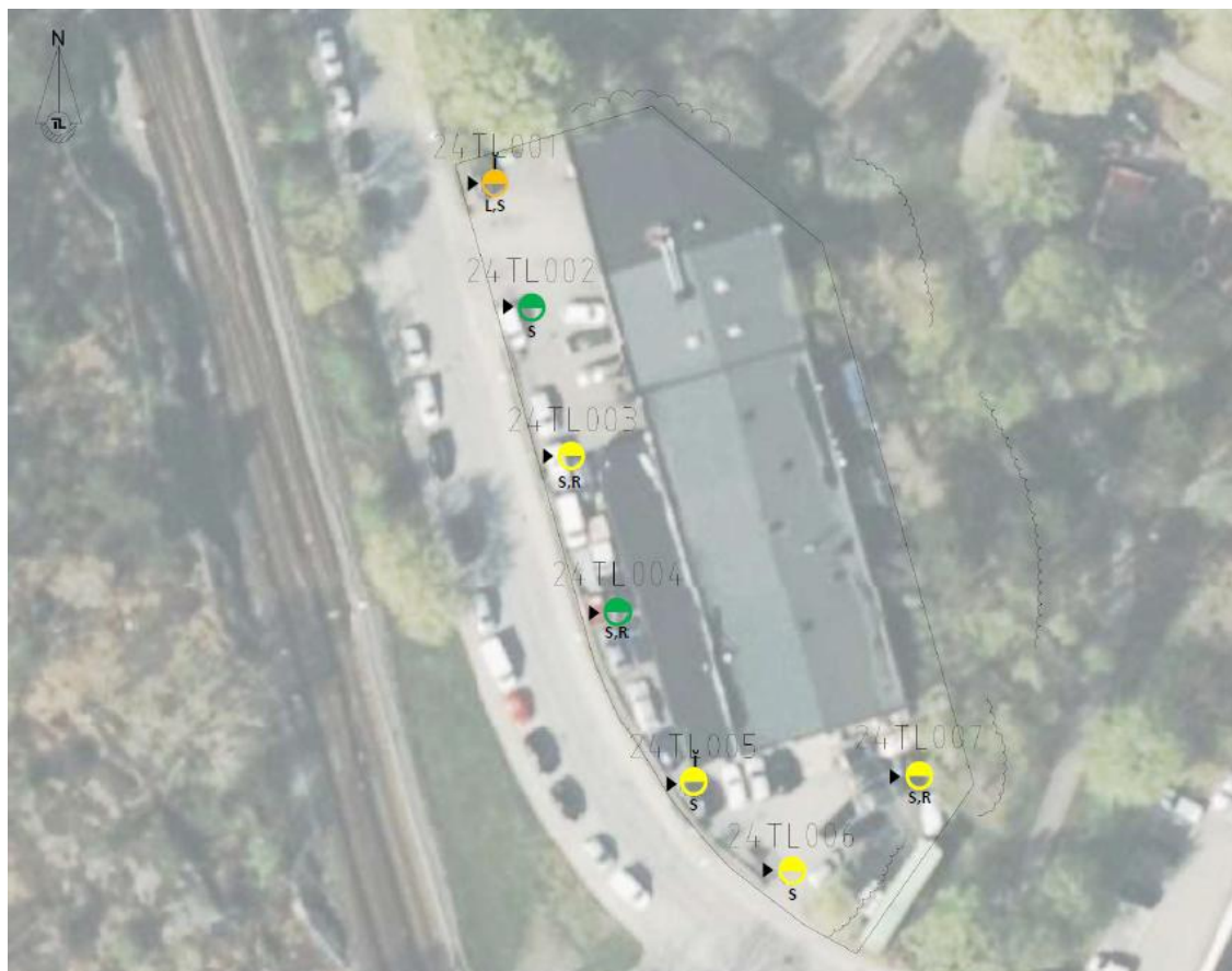
Figur 3: Provtagningspunkter med föroreningshalt. Grön punkt = inga överskridande halter. Orange punkt = halter över MRR. Gul punkt = halter över KM.
