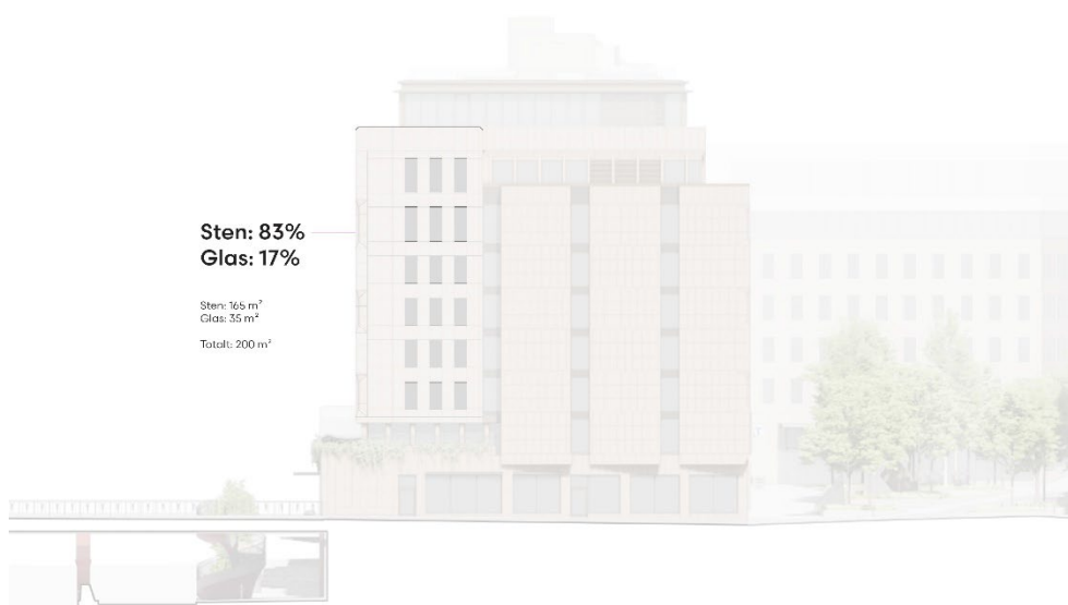
Figur 41. Illustration över andelen sten respektive glas i gavelfasaden. Källa: Tengbom.
