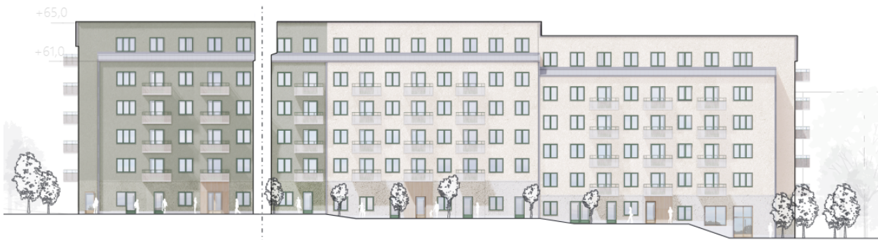
Fasadelevation mot gård. Den sjätte översta våningen är indragen från gården. Illustration: Belatchew
