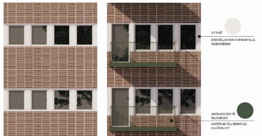
Illustration som visar ursprungligt utförande (t.v.) jämfört med förslag på större fönsterband och påhängda balkonger. (Bild: Strategisk Arkitektur).
