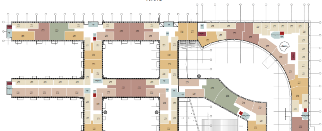
Exempel på planlösning som uppfyller kraven enligt trafikbullerförordningen (2015:216) genom att antingen placera genomgående lägenheter med tillgång till tyst sida, alternativ små lägenheter mot bullerutsatta fasader. (Bild: Strategisk Arkitektur)
