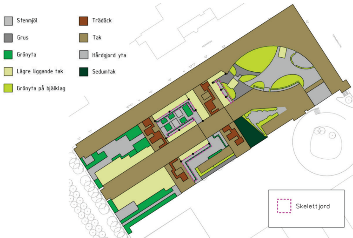
Illustration som visar föreslag på skelettjordar tillsammans med övriga ytor inom planområdet. (Bild: Novaterra).
