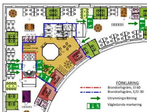
Figur 3. Befintlig utformning ljushus. Brandavskiljande parti blåstreckat.
