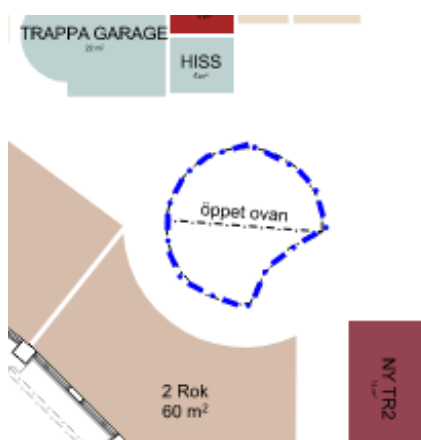
Figur 4. Exempel brandteknisk avskiljning ljushus vid framtida ändringar. Brandteknisk klass på avskiljningen detaljstuderas vid projektering.
