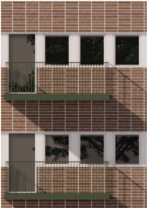
balkongdörr och påhängda balkonger
