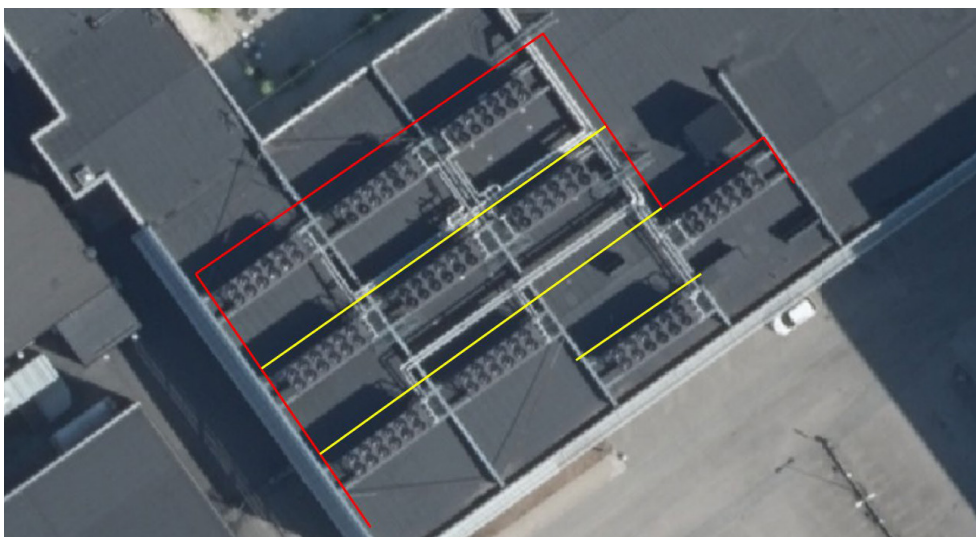
Figur 4. Röd skärm är absorberande på sidan mot kylmedelskylarna och gul skärm är absorberande på båda sidor.
