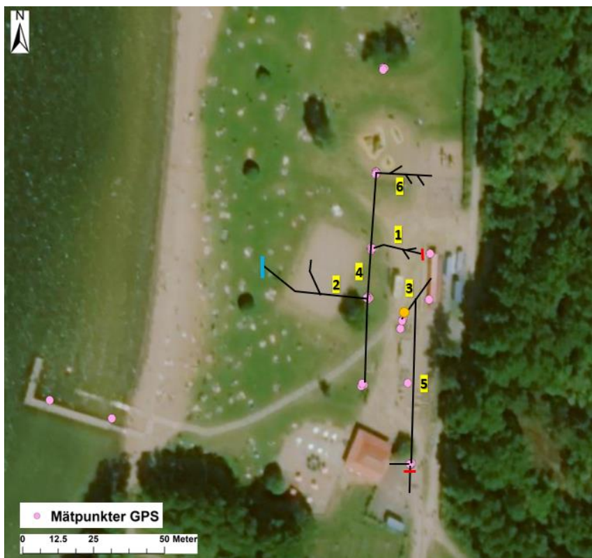
Figur 2. Karta över området med rosa prickar som markerar GPS-mätpunkter, blå markering betecknar anträffat vatten och röd markering betecknar täckt ledning. Siffrorna markerar olika ledningssträckor.
