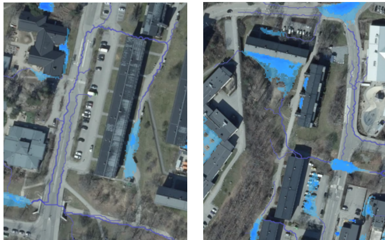
T.v. Lågområde samt skyfallsstråk mellan befintlig gångväg och Bredängs allé. Risk för såväl översvämning som erosionsskador. Scalgo
