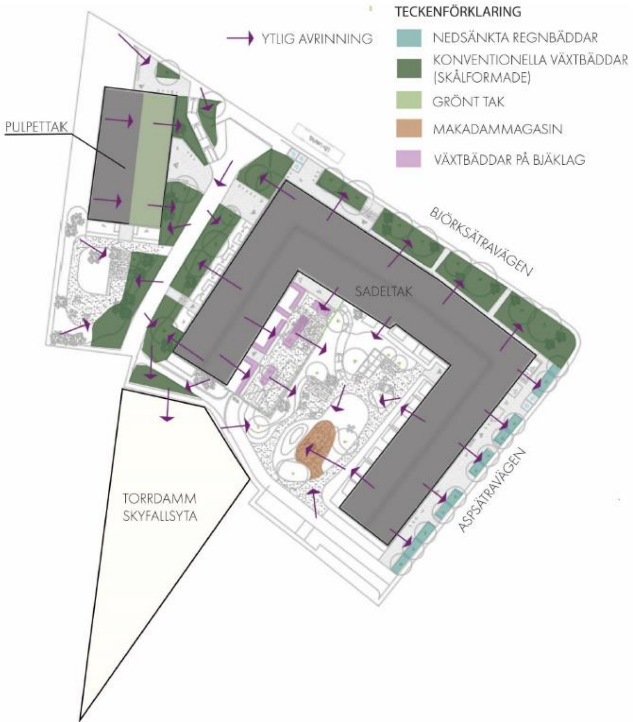
Föreslagen dagvattenhantering inom planområdet. Illustration Nyréns Arkitektkontor.
