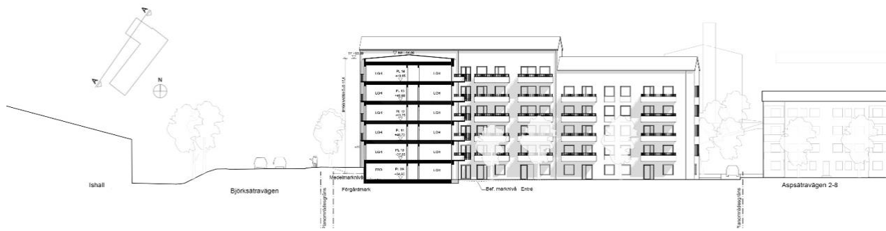
Sektion A-A, genom Björksättravägen och östra kvartershusets innegård. Arkitekt In Praise of Shadows Arkitektur
