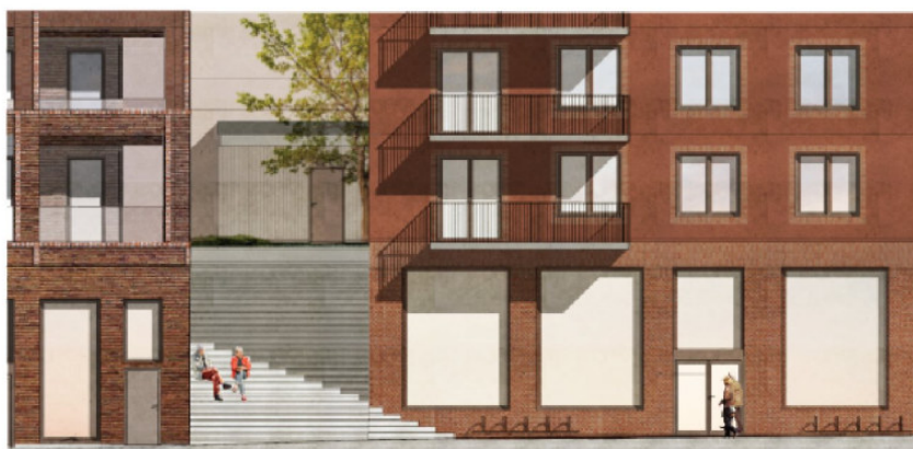
Fasadutsnitt visar sockelns gestaltning med stora fönsterglas och fasadmateriell som kontrasterar mot övrig fasad. Här ses entrén till en framtida lokalmöjlighet för dagligvaruhandel (t.h) och trappa upp till bostadsgård (t.v). Illustration: Arkitema.
